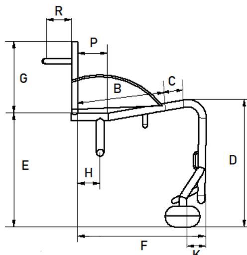
Mesures exprimées en mm - tolérances sur les mesures de +/- 10 mm
